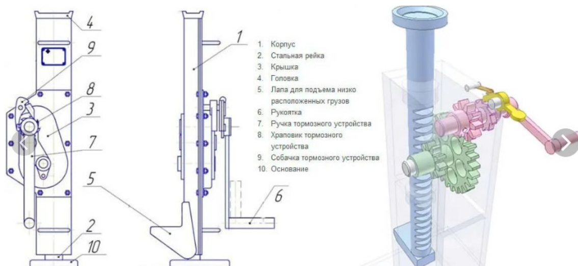
Рисунок 2 – Конструкция реечного домкрата
