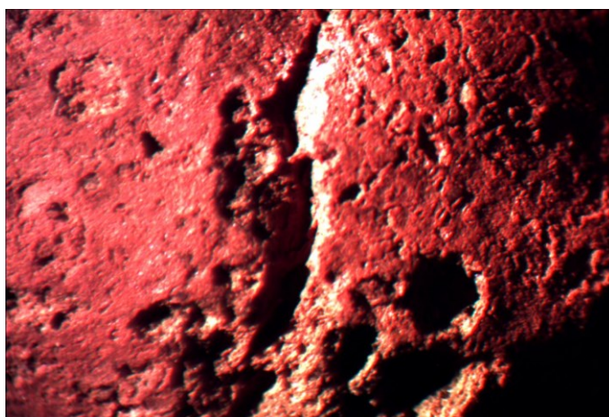
Рисунок 3 – Макроструктура внешней поверхности керамзитового гравия при увеличении в 40 раз
