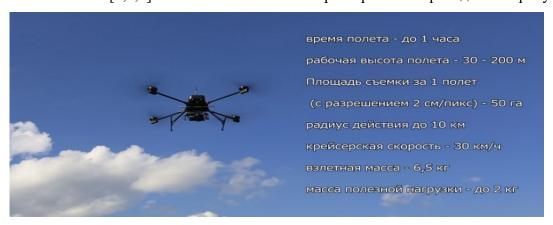
Рисунок 1. Тактово-технические характеристики БПЛА
