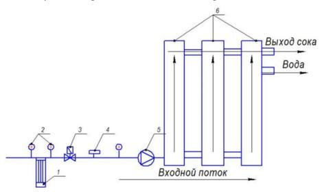
Рисунок 4 — принципиальная схема экспериментальной мембранной установки: 1 — предварительный фильтр; 2 — манометры; 3 — электромагнитный клапан;
