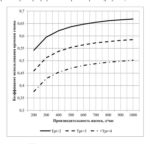
Рисунок 1 — Зависимость коэффициента использования времени смены от производительности насоса  $(V_b=10~{\rm m}^3,~{
