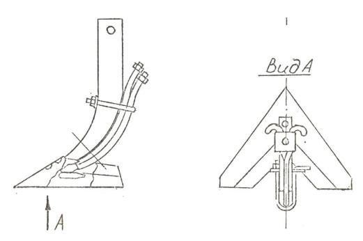
Рисунок 4. Рабочий орган культиватора КПС-4М. с двумя подкормочными трубками
