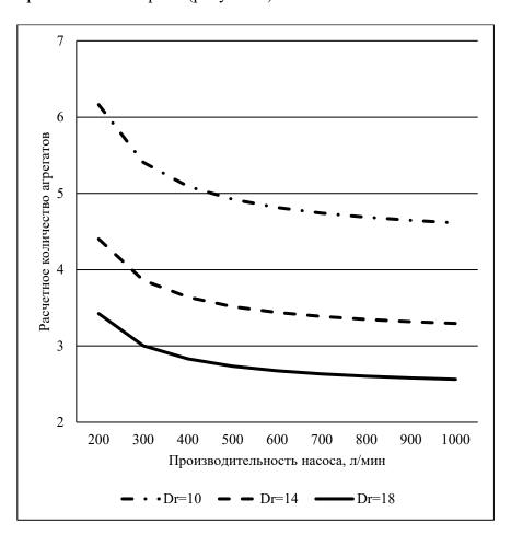
Рисунок 2 — Зависимость количества опрыскивателей от производительности насоса при загрузке рабочего раствора (Q=10000 га)
