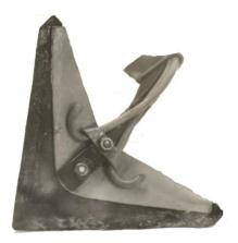
**Рисунок 5**. Рабочий орган культиватора КПС-4М. с двумя подкормочными трубками Из рисунка 6 видно, что зона распространения ЖКУ от одной подкормочной трубки в ширину составляет 20-22 см, в высоту до 8 см, форма разреза зоны в виде овала, вытянутого по горизонтали.
