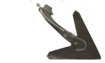
Рисунок 3. Рабочий орган культиватора КПС-4М. с одной подкормочной трубкой
