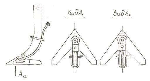
Рисунок 2. Рабочий орган культиватора КПС-4М. с одной подкормочной трубкой
