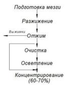
Рисунок 2 – схема производства диффузионного сока
