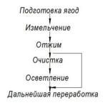
Рисунок 1 – схема производства сока прямого отжима
