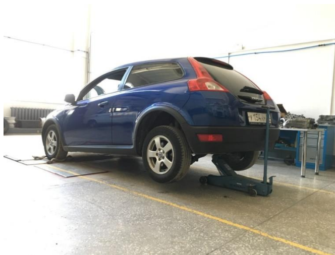
Рисунок 2 – Измерение веса передней оси Volvo C30 под нагрузкой
