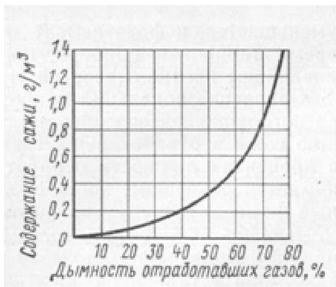
Так же существует способ измерения содержания сажи основанный на отфильтровывании частиц сажи из выхлопных газов. Но данный способ даёт менее надёжный результаты. Он позволяет только приблизительно определить дымность выхлопных газов сравнением цвета фильтра, на котором остались частицы сажи, с эталоном имеющим шкалу
