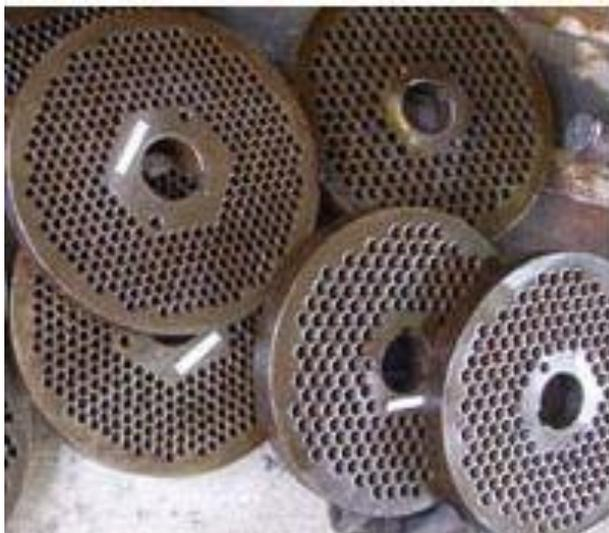
Рис.2 Матрицы различных типоразмеров
