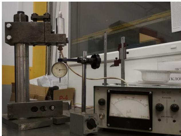
Рисунок 1 – Прибор виброконтактного типа
