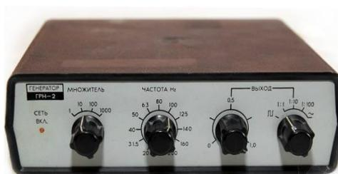
звуковой генератор частот
