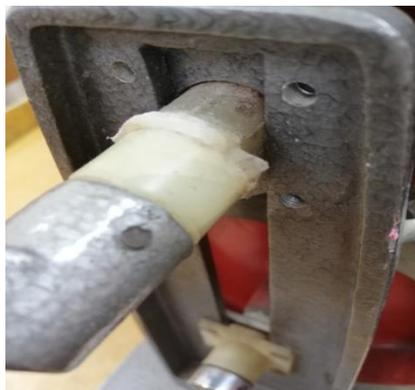
Рисунок 1. Поврежденный шарнир модели редуктора
