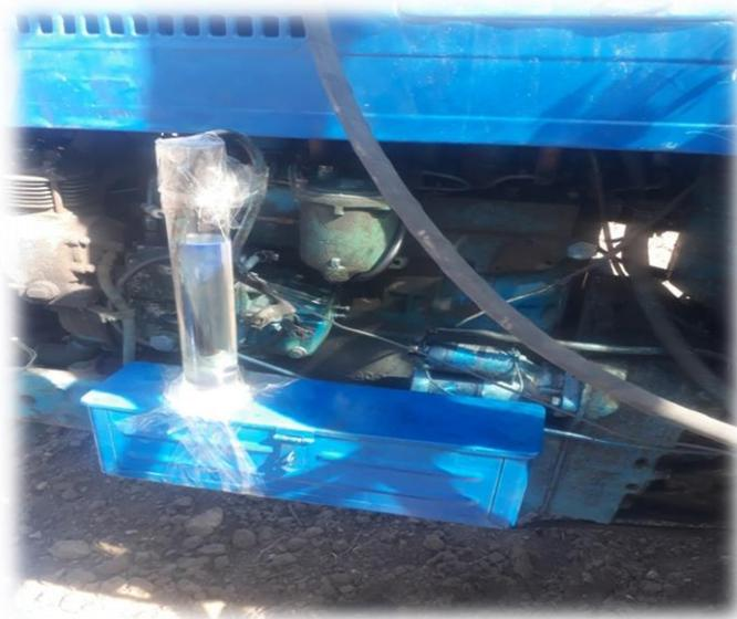
Рисунок 2 - Мерная колба с испытуемым топливом.
