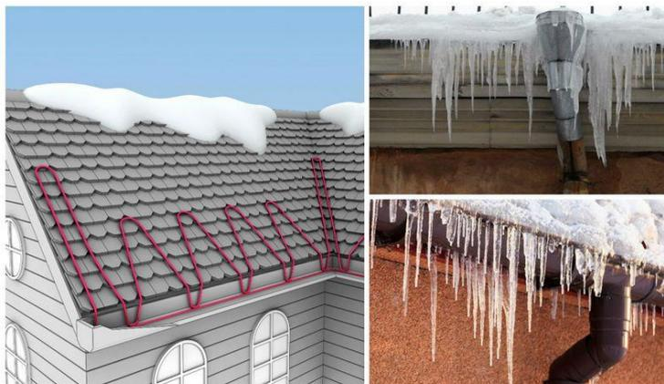
Рисунок 2 - Система антиобледенения кровли и водостоков
