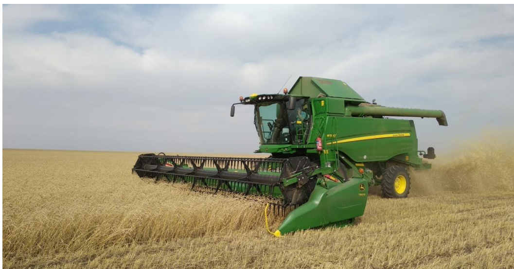
Рисунок 1 – Зерноуборочный комбайн «John Deere» модели W540i с жаткой «John Deere» модели 730FD в работе
