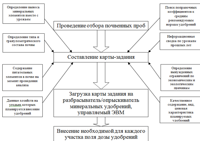
Рисунок 2 – Схема этапов технологического процесса дифференцированного внесения удобрений для режима off-line.
