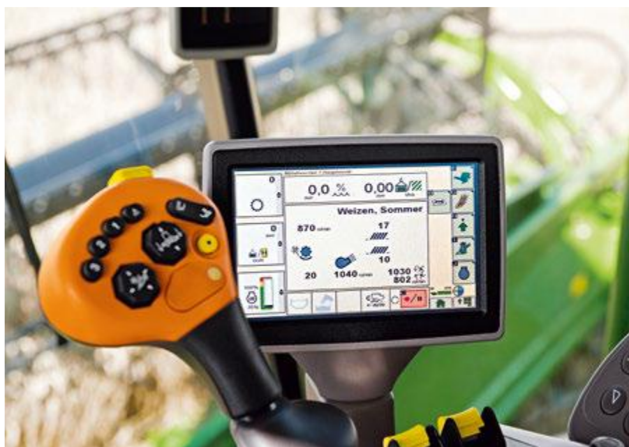
Рисунок 2 – Общий вид экрана-сенсора системы GreenStar 3 CommandCenter установленной в кабине зерноуборочного комбайна «John Deere»
